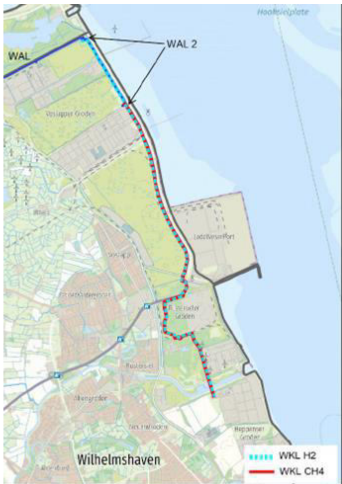
Abbildung 17: Geplante WAL2-Trasse und WKL-Trasse
