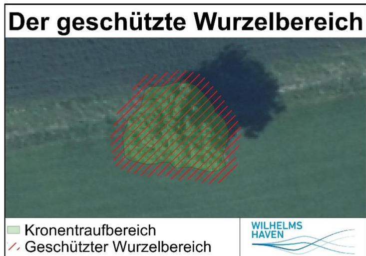
Abbildung 2: Der geschützte Wurzelbereich in der Aufsicht (eigene Darstellung)
